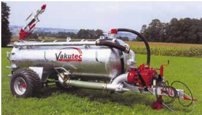
Fass mit Hochdruckkreiselpumpe
