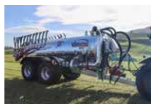
Vakum/Tandemfass 12500l mit Saugarm und Turbobü- ler (Kombination)
