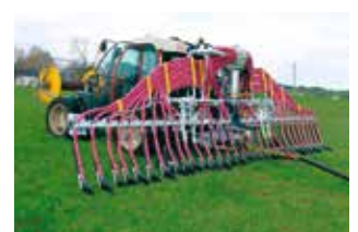
Schleppschuhverteiler mit 7m Arbeitsbreite
