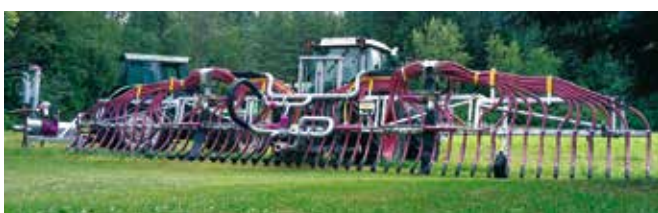
Schleppschuhverteiler mit 12m Arbeitsbreite. Dieser Verteiler ist in West-Kanada im Einsatz.
