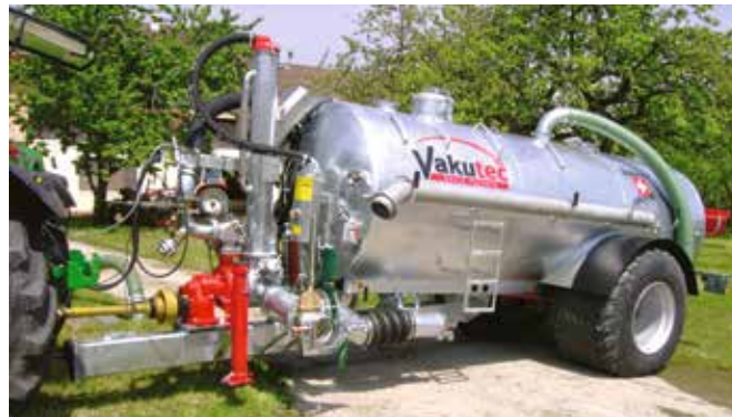
Fass mit eingelassenen Radkästen
