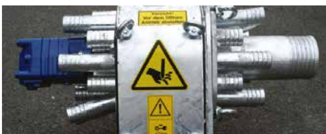
Alle Verteiler mit EXA-CUT (Vogelsang) ausgerüstet
