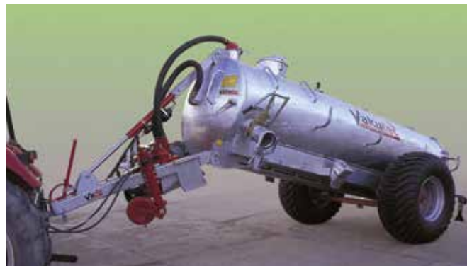
Vario Deichsel Stufenlose Höhenverstellung des Zugdeichsels
