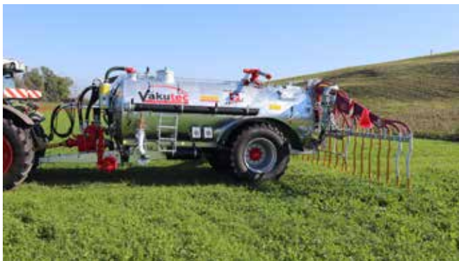
Vakutecfass Kombiausführung 6500l mit hydraulischer Vario-Weitwurfdüse, verstellbare Achse, Einfülldom, Aufstiegsleiter, Durchflussmengenmessgerät usw..
