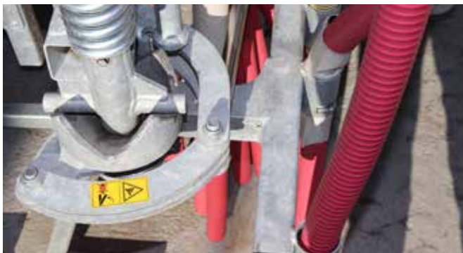
Seitenarme mit Anfahrtsicherung und Zylinder
